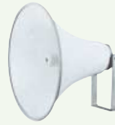
トランペットスピーカー S-036 25W(400)トランス付き サイズ: 504×472 重量4.1kg S-037 50W(200)トランス付き サイズ: 601 重量6.2kg
