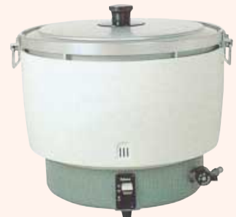
炊飯器 55合 サイズ: W584×D470×H449 重量: 13.2kg 炊飯能力: 3.6 - 10L(20 - 55合) 毎時ガス消費量: LPG9.91kw 都市ガス11.2kcal
